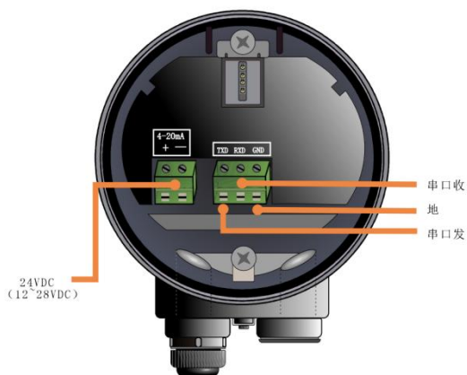
图 14 24VDC 两线制接线图
