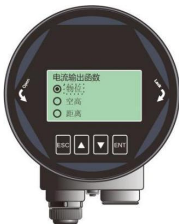
图 43 电流输出函数编辑界面
