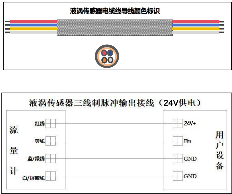
图 11 脉冲输出接线示意图
