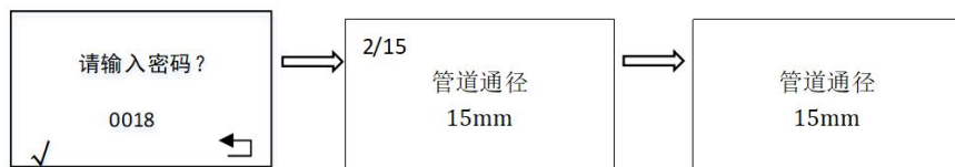
图 15 管道通径设置
